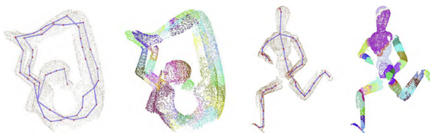
Figura 49 – Esqueletização do algoritmo adaptado para nuvens de pontos Fonte: Jiang et al. (2013) adaptada pelo autor
